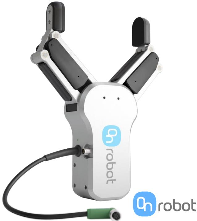
Le préhenseur RG6 de OnRobot est une solution Plug & Work pour les robots collaboratifs.
