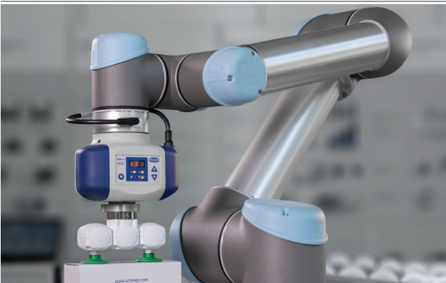
Générateur de vide électrique ECBPi lors de la manipulation de boîtes en carton
