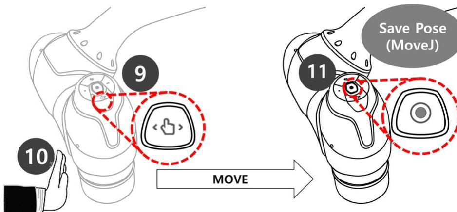
12. D'une main, appuyez sur le bouton de guidage manuel, qui a une forme de main, situé sur le cockpit en haut de l'extrémité du robot. Les étapes 12 à 14 enregistrent la pose de MoveL.
