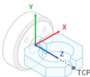
Les valeurs de décalage de l'onglet TCP peuvent être calculées à l'aide de la fonction de calcul automatique. Le décalage TCP peut être calculé en déplaçant le robot avec 4 poses centrant le TCP.
