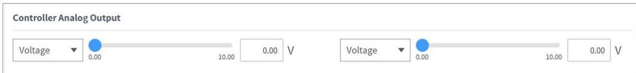
1. Appuyez sur la liste déroulante de la sortie analogique du contrôleur pour sélectionner l'élément à configurer.
