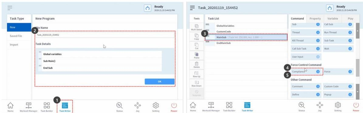
6. Sélectionnez la commande conformité sur la quatrième ligne. Une nouvelle commande est ajoutée à la ligne suivante de la ligne sélectionnée.
