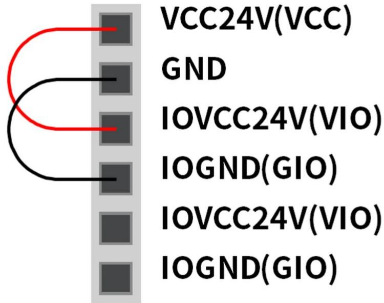
Si un courant de plus de 2 A est requis, séparez VCC et GND. Il sera nécessaire de connecter une source d'alimentation externe séparée (24 V) à l'aide des bornes VIO et GIO.
