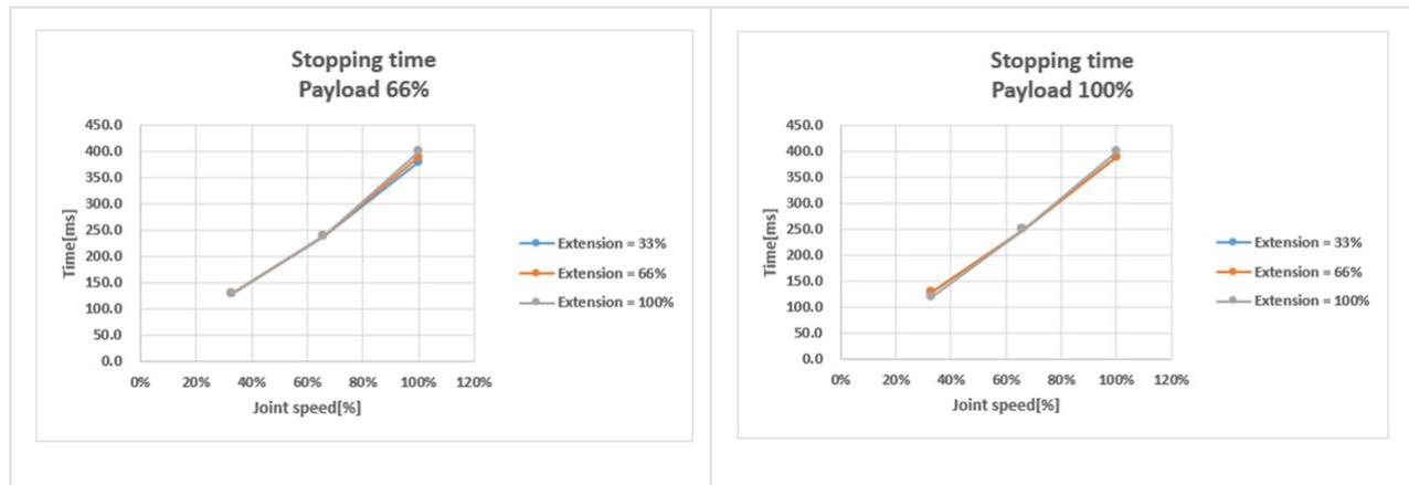
Distance d'arrêt et temps d'arrêt de l'articulation 3 (coude)
