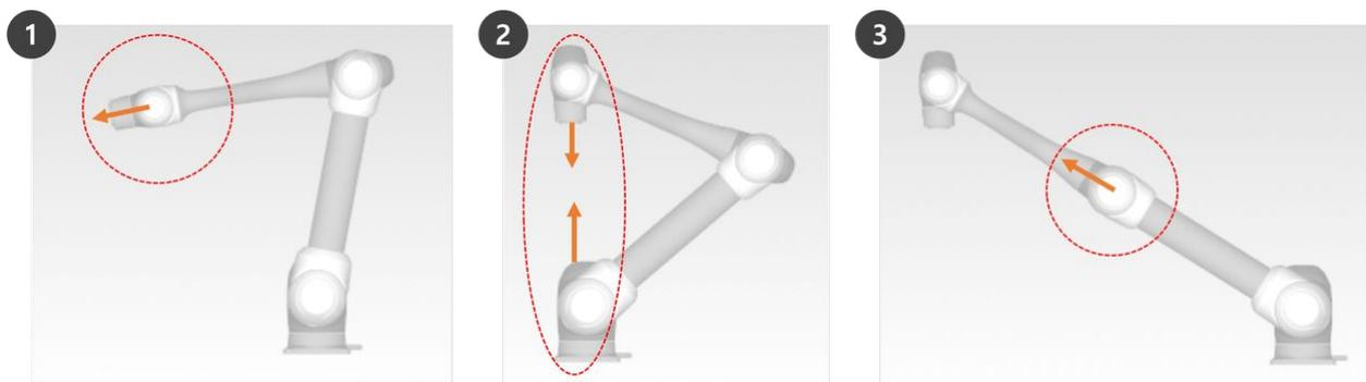
1. Singularité du poignet : Lorsque le poignet du robot forme une ligne à mesure que l'axe 5 s'approche de  $0^\circ$
