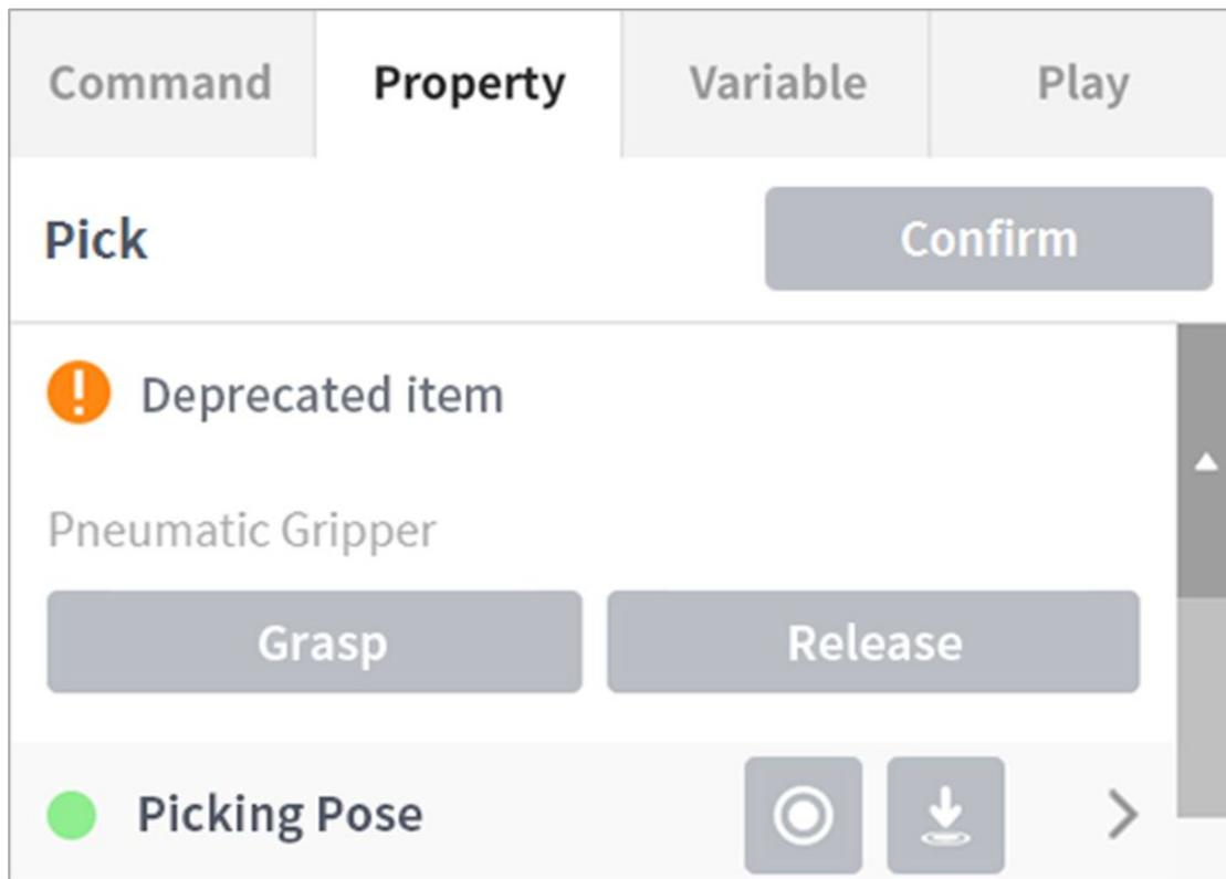
Si une commande de compétence obsolète est présente, il est recommandé de la remplacer par une commande de compétence à jour.
