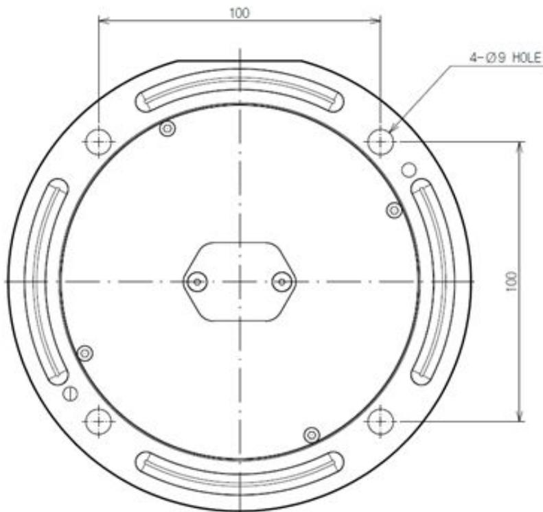
**Dessin de la base du manipulator, utiliser quatre boulons M8. Unité [mm]**
