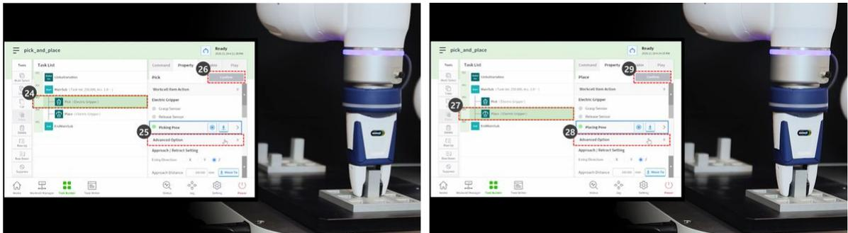
30. Utilisez l'apprentissage direct pour déplacer le robot jusqu'au point de départ de Pick&place.
