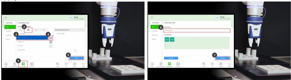
8. Sélectionnez la commande MainSub sur la deuxième ligne de la liste des tâches. Une nouvelle commande est ajoutée à la ligne suivante de la ligne sélectionnée.
