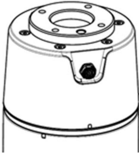
Le connecteur fournit l'alimentation et les signaux de contrôle nécessaires au fonctionnement de la pince de préhension ou des capteurs intégrés dans les outils spécifiques du robot. Les câbles suivants sont des exemples de câbles industriels (des câbles équivalents peuvent être utilisés) :
