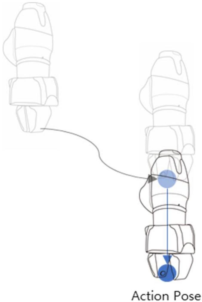
**Move to Retract Pose (Passer à la pose de retrait)** : il s'agit du point pour saisir la pièce et la déplacer en toute sécurité vers un autre point. Il s'agit de la direction Z de la pose d'approche, une autre direction pouvant également être sélectionnée. La distance de retrait saisie est automatiquement calculée pour la pose d'action et le robot se déplace vers le point correspondant.
