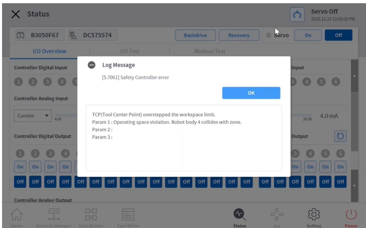
Si le robot s'est arrêté en raison d'une limite d'espace et de violations de zone, utiliser la **fonction État > récupération de sécurité > récupération du logiciel** pour déplacer le robot vers une zone sûre. L'exemple suivant montre comment déplacer le robot vers une zone sûre à l'aide de la fonction de récupération logicielle.
