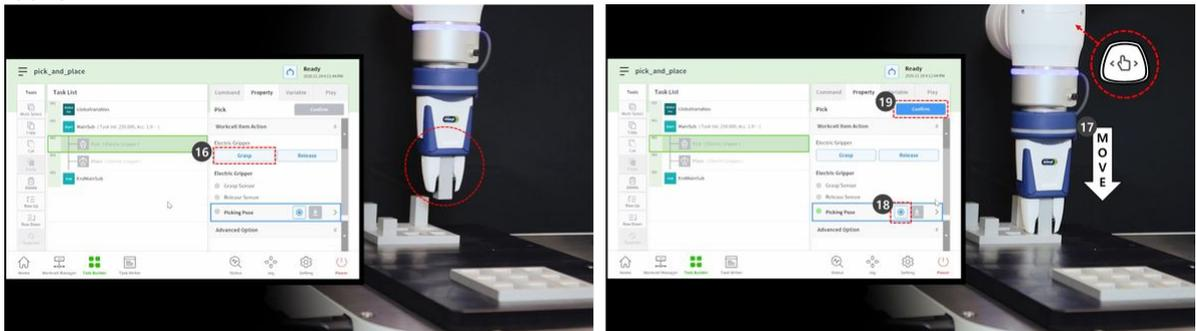
20. Utilisez l'apprentissage direct pour déplacer le robot jusqu'au point où la place sera effectuée.
