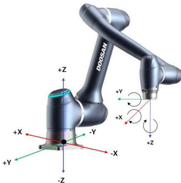
1. Sélectionnez les coordonnées de la base. Le robot peut être déplacé en fonction des coordonnées DE BASE ou des coordonnées DE L'OUTIL.
