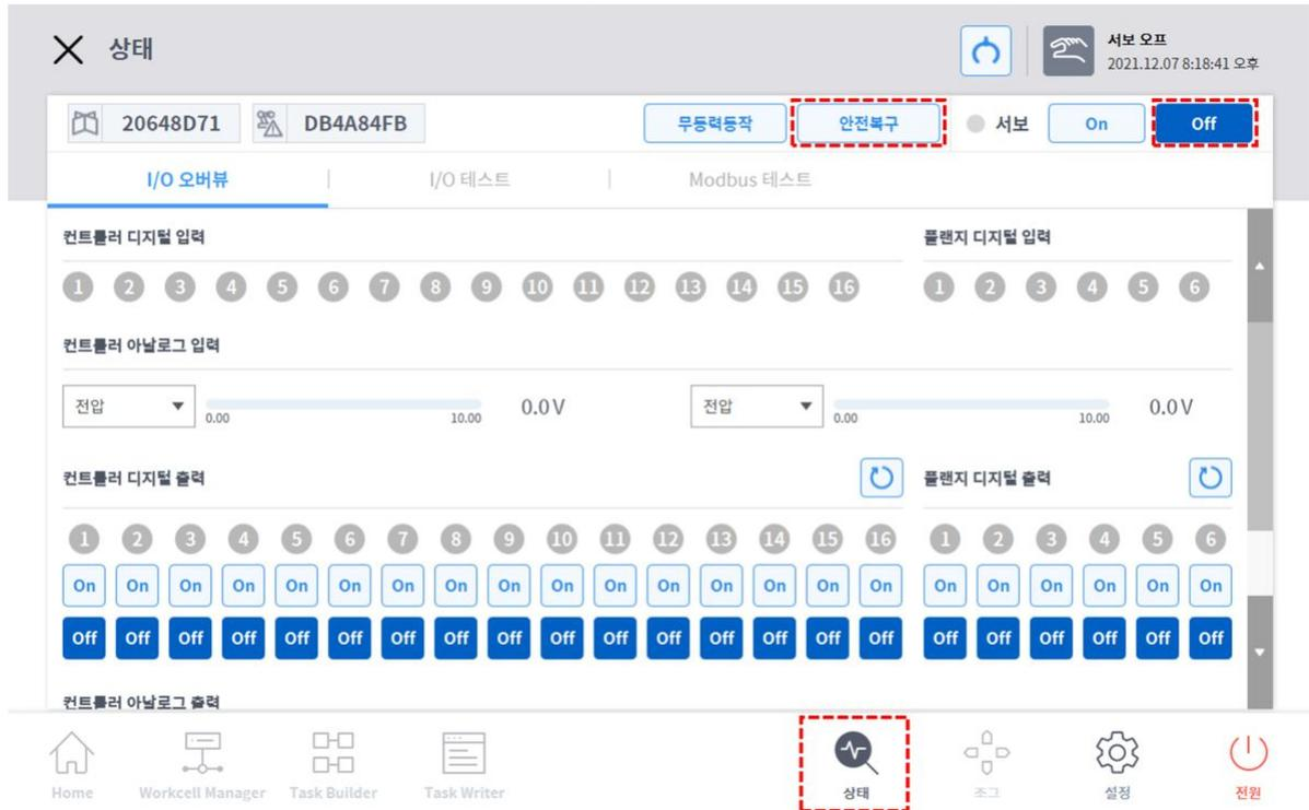
2. Appuyez sur le bouton **récupération de sécurité**. Le bouton de récupération de sécurité est activé lorsque le **mode Servo Off** est activé.
