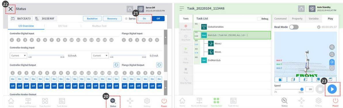
24. Régler le bouton bascule du mode réel sur l'état d'activation (vert) pour faire fonctionner le robot.
