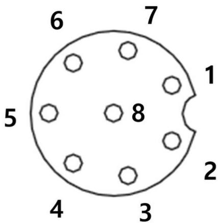
Les fonctions E/S fournies par le connecteur X1 sont différentes l'une de l'autre ; le tableau ci-dessous indique les paramètres d'E/S détaillés.
