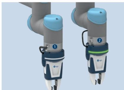
Pour les robots Universal Robots et Techman Robot, deux versions de la pince Co-act EGP-C sont disponibles. Les versions -URID ou -TMID utilisent le faisceau interne du robot pour transmettre les signaux vers le contrôleur du robot. Cependant, cette version n'a pas de bande lumineuse. Le bande lumineuse incluant son activation ne peut être utilisée que avec la version avec câble externe.
