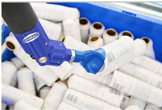
Ventouse SVE pour retirer les bombes aérosol d'un bac.
