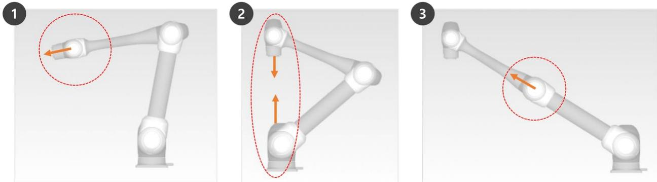
1. Singularité du poignet : Lorsque le poignet du robot forme une ligne à mesure que l'axe 5 s'approche de  $0^\circ$
