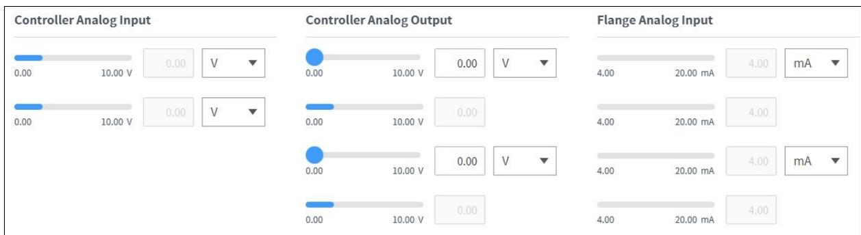
1. Appuyez sur la liste déroulante de l'entrée analogique du contrôleur/bride pour sélectionner l'élément à vérifier.
