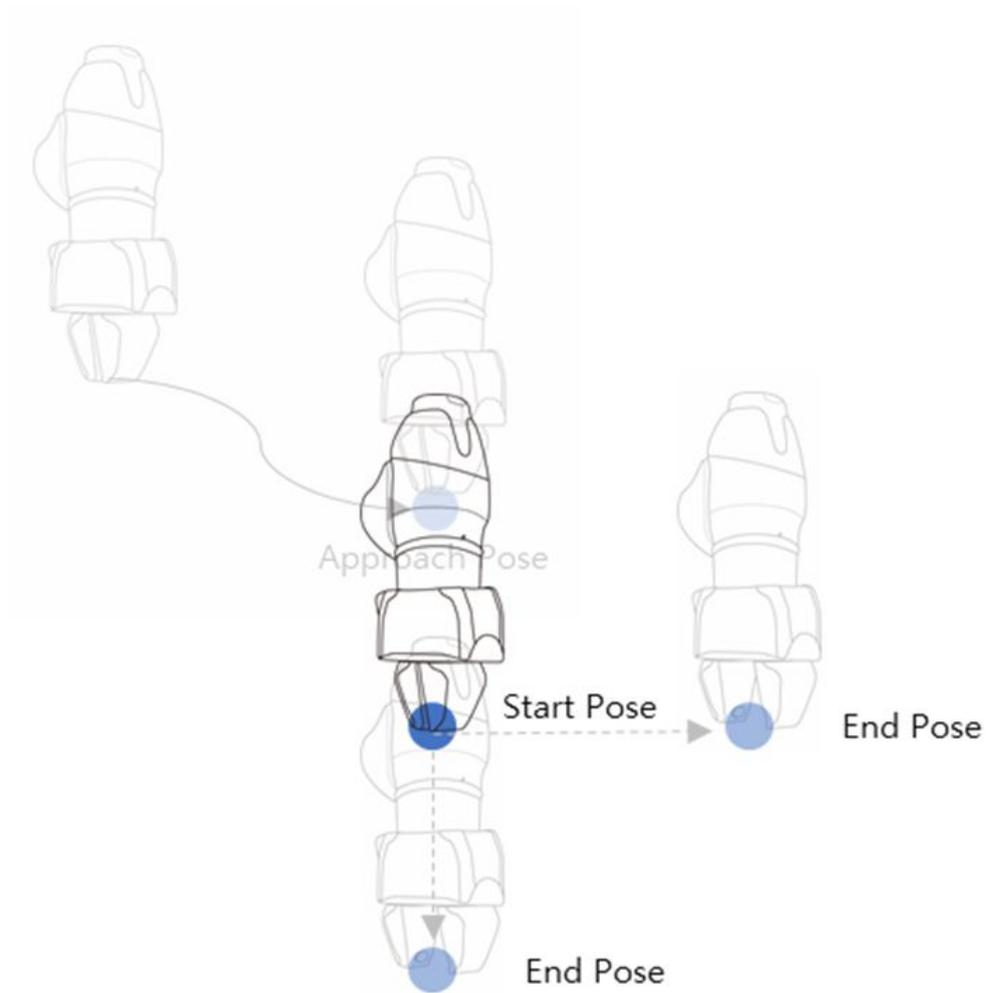
**Move to End Pose (Passer à la pose de fin)** : Si la cible d'exécution de l'effecteur final ne se termine pas en un mouvement unique, il peut y avoir un point intermédiaire et un point final, la pose de fin d'action étant le point final de la tâche (par ex. Door\_OpenClose Skill [Compétence porte ouverte/fermée] - End Pose [Pose de fin])
