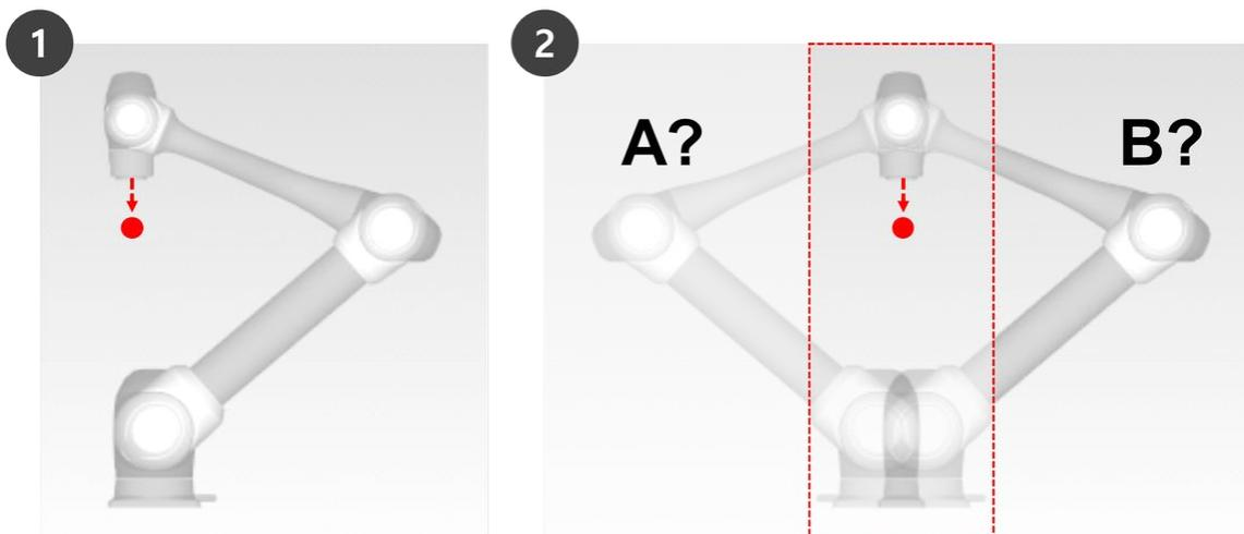
Près d'une singularité, le mouvement du robot n'est pas fluide en termes de plan, de point et de ligne, le mouvement linéaire d'extrémité du robot peut ne pas être maintenu et l'erreur de position pendant le contrôle peut augmenter. La singularité se produit dans trois cas, comme illustré dans la figure suivante, y compris lorsque les liaisons du robot forment une ligne.
