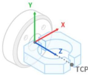
Les valeurs de décalage de l'onglet TCP peuvent être calculées à l'aide de la fonction de calcul automatique. Le décalage TCP peut être calculé en déplaçant le robot avec 4 poses centrées sur le TCP.
