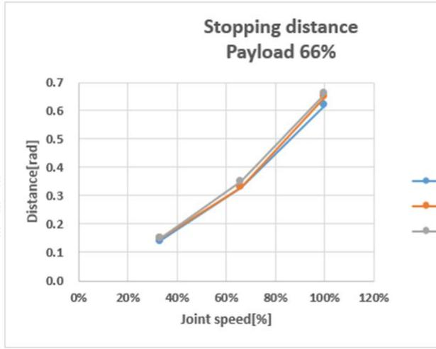
**Distance d'arrêt avec charge max. (rad)**
