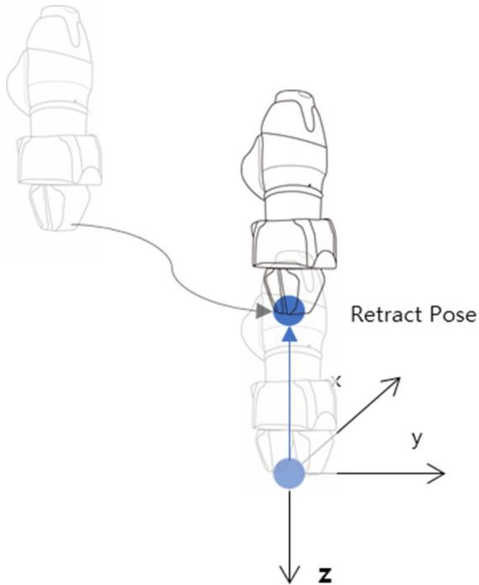
**Move to Start Pose (Passer à la pose de début)** : si la cible d'exécution de l'effecteur final ne se termine pas en un mouvement unique, il peut y avoir un point intermédiaire et un point final, la pose de début d'action étant le point de départ de la tâche (par ex. Door\_OpenClose Skill [Compétence porte ouverte/fermée] - Start Pose [Pose de début])
