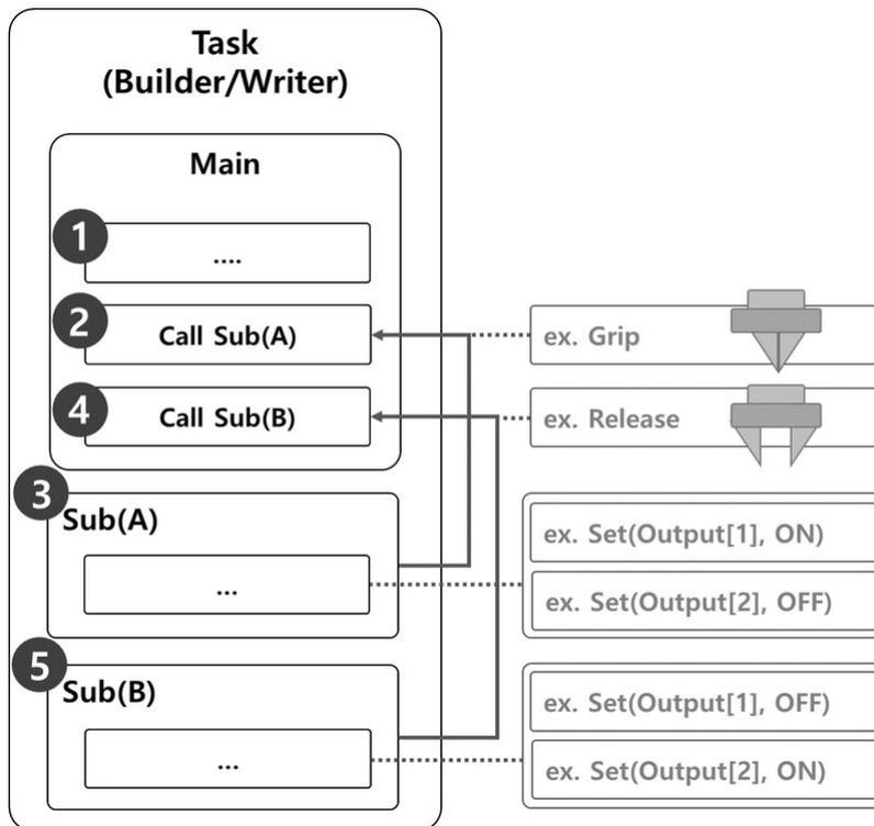
L'exemple où une sous-commande est utilisée pour exécuter les mouvements de préhension et de relâchement d'une pince robot comprend les éléments suivants.
