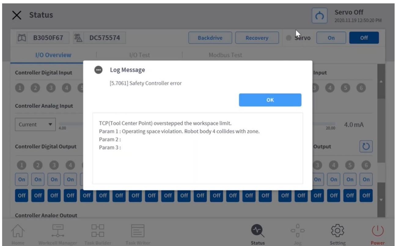
Si le robot s'est arrêté en raison d'une limite d'espace et de violations de zone, utiliser la **fonction État > récupération de sécurité > récupération du logiciel** pour déplacer le robot vers une zone sûre. L'exemple suivant montre comment déplacer le robot vers une zone sûre à l'aide de la fonction de récupération logicielle.
