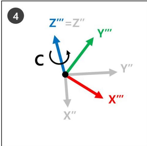
5. Les nouvelles coordonnées (Z''', y'', X''') de l'étape 4 font référence à la rotation actuelle du robot lorsque les angles d'Euler A, B et C sont appliqués.
