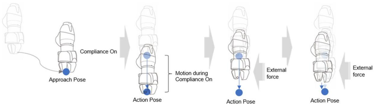
**Contact Check** (Vérification de contact) : Sur la base des valeurs de **force de contact** et de **plage de détermination du contact** entrées, la fonction détecte le contact avec la cible, s'arrête à la position correspondante et active la pince de préhension pour saisir la cible.
