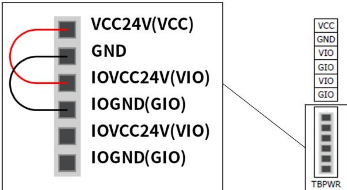
Si un courant supérieur à 2 a est requis, il est nécessaire de connecter une source d'alimentation externe séparée (24 V) aux bornes VIO et GIO.
