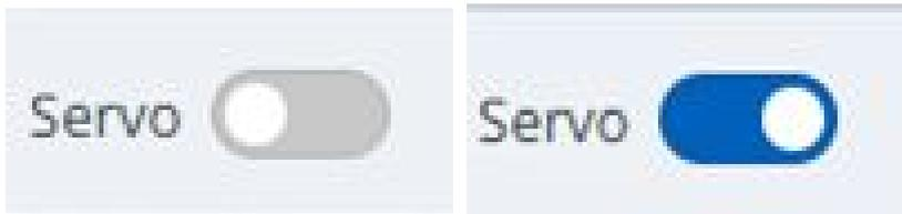
**Servo on** fait référence à l'état de veille où le bras du robot peut être actionné en alimentant les articulations. Appuyer sur le bouton d'arrêt d'urgence ou violer les limites de sécurité critiques désactive le servomoteur . Lorsque le servo est désactivé, l'alimentation des joints est coupée, ce qui empêche le bras du robot d'être utilisé, et **l'éditeur de tâches et Jog plus**, qui sont liés au fonctionnement du bras robot, sont désactivés dans le menu principal.
